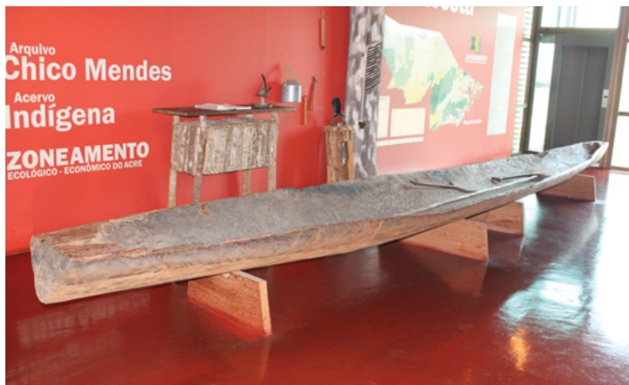
Canoa esculpida artesanalmente em um único tronco, empregada pelos indígenas, seringueiros e ribeirinhos (povos da floresta) como transporte nos grandes rios da Amazônia. Biblioteca dos Povos da Floresta. Rio Branco — Acre. Foto: Adriano Toledo Paiva.
